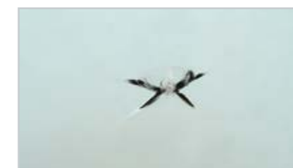
c) Kombinirano oštećenje
