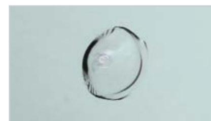
a) Točkasto oštećenje
